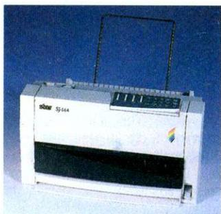
wendet werden. Die Anlagekante an der Druckerrückseite ist unzureichend. Bis die Halbautomatik das Medium einzieht, ist die Gefahr recht hoch, das Blatt zu verschieben. Der vordere Blatteinzug ist für dünneres Papier gedacht. Eingelegte Blätter werden um 180 Grad gedreht und dürfen daher nicht zu starr sein.
