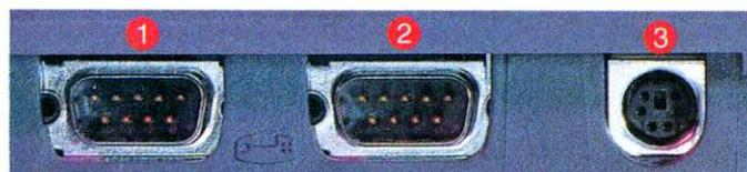
**Eingabeschnittstellen:** Zwei Maus/Joystick-Ports (1 und 2) sowie ein Anschluß für eine externe Tastatur (3)
