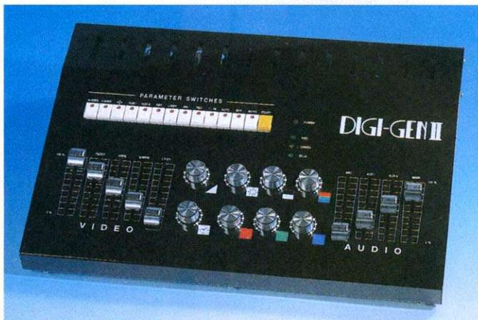
**Digi-Gen II: Das Genlock ist mit einem Effektgenerator, Farbsplitter, Audiomischpult und Videogenerator ausgestattet**
